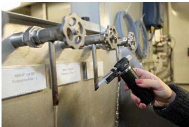
Abflammen einer Probenahmestelle
