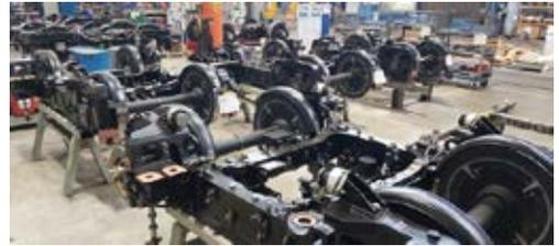
Beim Hersteller HeiterBlick in Leipzig stehen die Fahrwerke und Drehgestelle der neuen Straßenbahnen bereit zur Montage.
