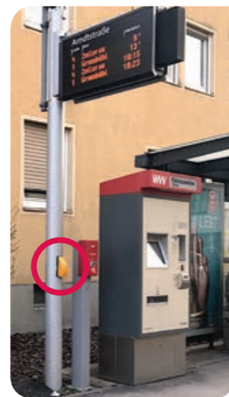
Dynamische Fahrgastinformation (DFI) mit Sprachansage
